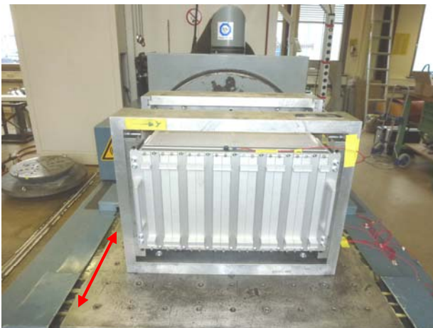
1: Prüfobjekt in x-Achse auf dem Gleittisch
