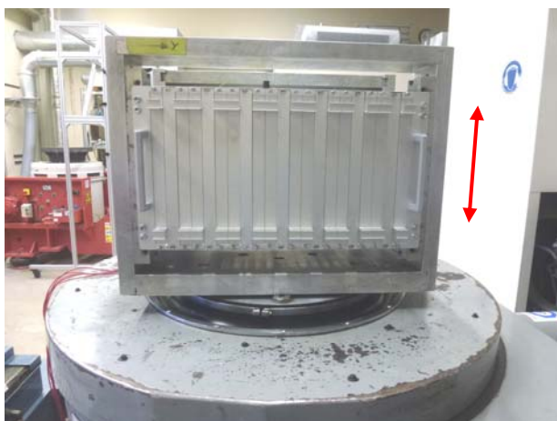
3: Prüfobjekt in z-Achse auf dem Head-Expander
