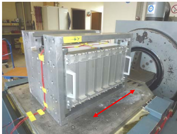
2: Prüfobjekt in y-Achse auf dem Gleittisch
