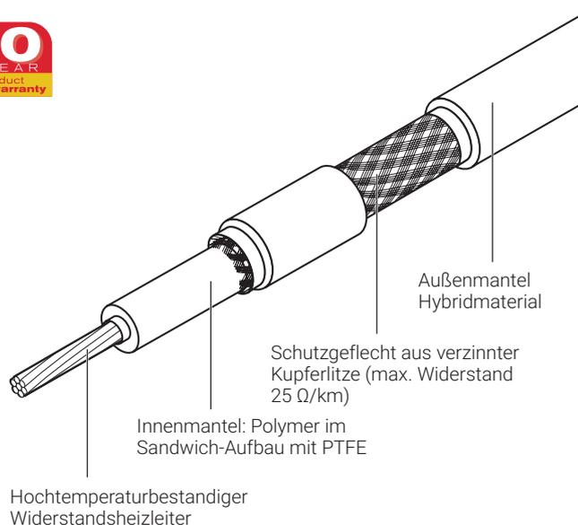
nVent RAYCHEM XPI-F ist ein polymerisiertes (PI) Heizkabel, das sich für den Einsatz in Ex- und Nicht-Ex-Bereichen eignet. Es ist ausgelegt für den Frostschutz und die Temperaturhaltung in niedrigeren Temperaturbereichen von Rohrleitungen, an Tanks und für andere Ausrüstungen.
