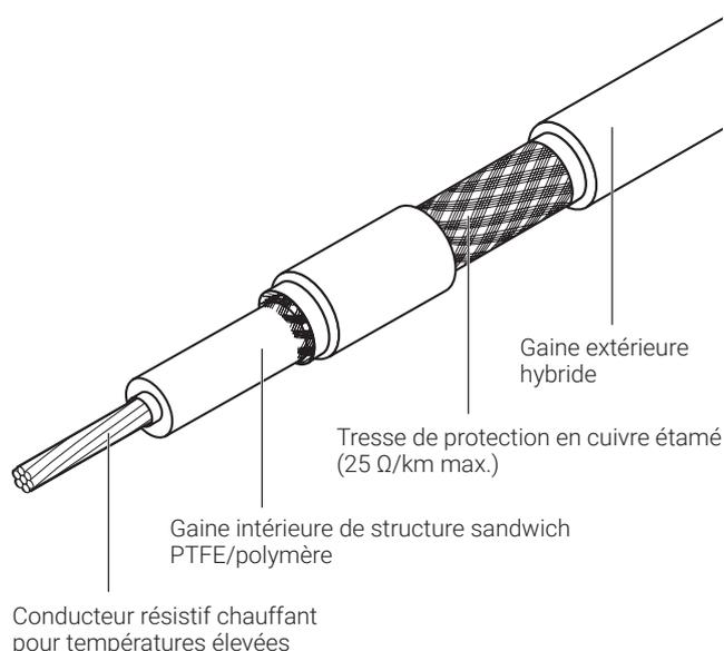
Le câble chauffant série à isolant polymère (PI) nVent RAYCHEM XPI-F convient pour un usage en zones ordinaires et explosibles. Il a été conçu pour les applications de mise hors gel et de maintien à basse température de tuyauteries, réservoirs et autres types d'équipements.
