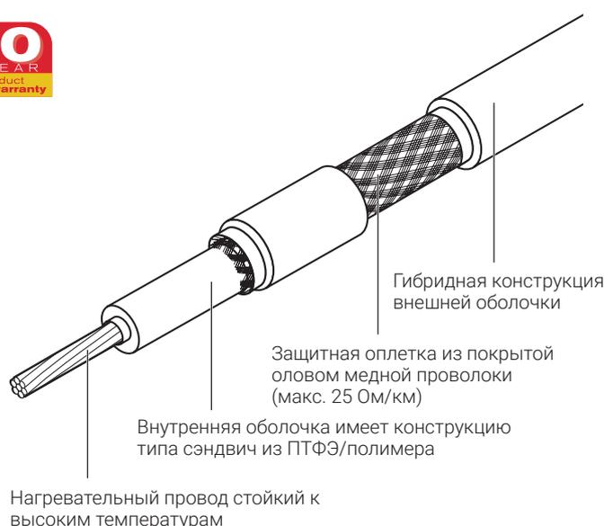
nVent RAYCHEM XPI-F – это греющие кабели последовательного типа с полимерной изоляцией, которые подходят для эксплуатации в нормальных и опасных зонах. Предназначены для использования в системах защиты от замерзания и поддержания низкой температуры трубопроводов, резервуаров и другого оборудования.
