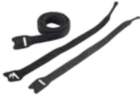
Maintient solidement le câble au chemin de câbles et se détache facilement pour l'entretien des câbles. La largeur du VELCRO® est de 12,7 mm (0,5 po). Disponibles en longueurs de 203 et 305 mm (8 et 12 po), aussi bien en version à vis qu'en version enroulable. Les vis auto-taraudeuses M5 sont utilisées sur les cadres ProLine.
