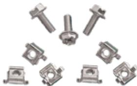
Permet de fixer les composants au système de grille. Les ensembles PGF comprennent 20 écrous à pince à fixation frontale (M6) et 20 boulons à tête à rondelle combinée. L'ensemble de M.A.L.T. est utilisé avec les trous rectangulaires du cadre ProLine pour assurer une continuité électrique entre le cadre et le système de grille. L'ensemble ASM5T est utilisé avec les cadres ProLine à trous ronds. L'emballage comprend 20 vis auto-taraudeuses M5.
