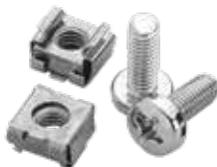
L'ensemble comprend un jeu de 8 écrous à cage et vis. Utilisé pour le montage d'équipement en étagère de 19 po sur trous carrés de 9 mm dans les supports verticaux. Les écrous à cages sont métriques (M6). Les vis sont à tête cylindrique métrique Philips M6x16.
