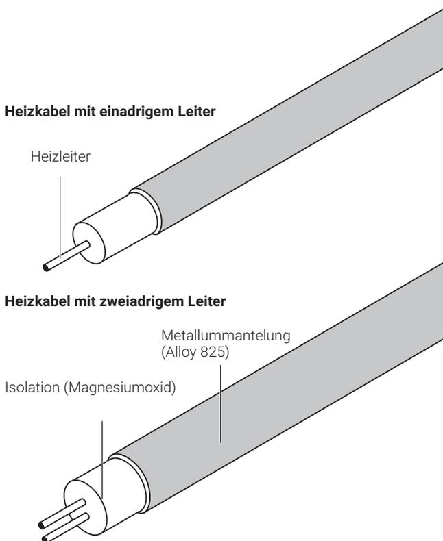
Mineralisierte (MI) nVent RAYCHEM-HAX-Heizkabel aus Alloy 825 von nVent sind für den Einsatz in Ex-Bereichen geeignet. Sie sind ausgelegt für den Frostschutz und die Temperaturhaltung von Rohrleitungen, an Tanks und für andere Ausrüstungen.
