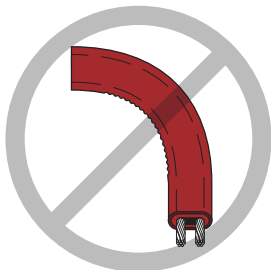
Figura 7: Curvatura do cabo aquecedor SC
