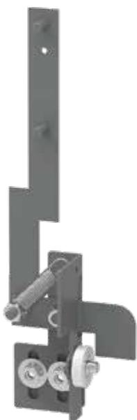
Le mécanisme de déverrouillage de l'opérateur assure une connexion entre la position de la poignée de la porte principale et le sectionneur. Si la poignée de la porte principale est ouverte, le sectionneur ne peut pas être activé.
