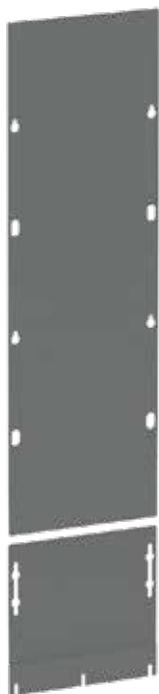
Le panneau de séparation est utilisé pour fournir une barrière de type 1 entre les armoires Universelles autoportantes individuelles. La conception en deux pièces se monte à l'intérieur de l'armoire, réduisant le point de fuite, le temps d'installation et la complexité. Aucun matériel supplémentaire n'est requis pour installer la séparation une fois les armoires assemblées en baie.
