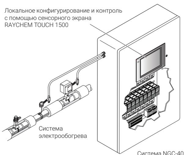
nVent RAYCHEM NGC-40 — многоточечная электронная система контроля, управления и энергораспределения с уникальной архитектурой одноточечных контроллеров, обеспечивающей наиболее надежное решение для централизованного управления и контроля для вашей системы управления теплом. Используя преимущества инновационной модульной технологии, система NGC-40 обеспечивает гибкость конфигурации и компонентов, что позволяет оптимизировать ее для конкретных проектных нужд каждого клиента.
