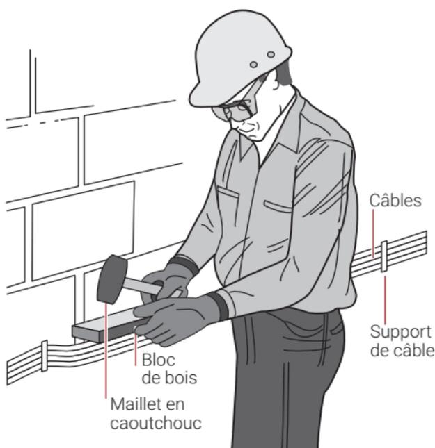
**Figure 8: Redressement et enveloppement de câble à isolation minérale**
