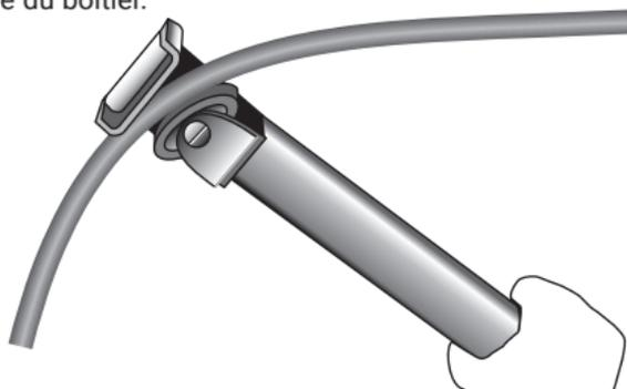
**Figure 9: Pliage de câble à isolation minérale à l'aide d'un outil de pliage**
