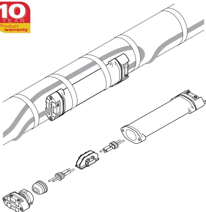
nVent RAYCHEM S-150 est une jonction en ligne installée à froid sous calorifuge. Elle est conçue pour s'adapter à tous les rubans chauffants nVent RAYCHEM à usage industriel (BTV, QTVR et XTVR), ce qui simplifie la sélection des produits et permet de réduire les stocks. Elle convient pour des applications à des températures allant de  $-55\text{ }^{\circ}\text{C}$  à  $200\text{ }^{\circ}\text{C}$  et est agréée pour un usage en zones explosibles.
