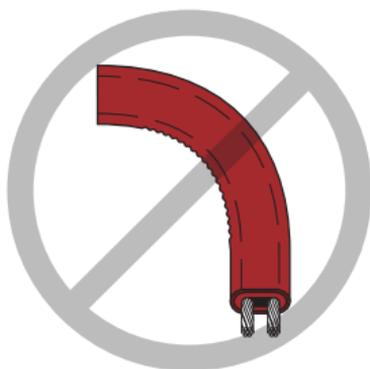
**Figure 7: Doblado del cable calefactor SC**
