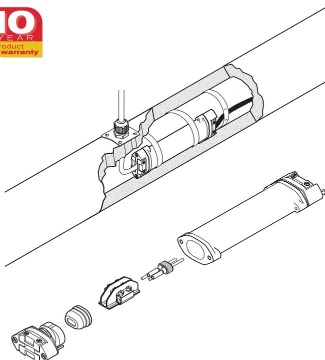
Le kit nVent RAYCHEM C-150-E est un boîtier d'alimentation de faible épaisseur qui s'installe à froid. Il permet de connecter en ligne des rubans chauffants nVent RAYCHEM pour applications industrielles, de type BTV, QTVR et XTVR, à un câble d'alimentation flexible. Il convient pour des applications à des températures comprises entre  $-55\text{ °C}$  et  $200\text{ °C}$  et est agréé pour un usage en zones explosives.
