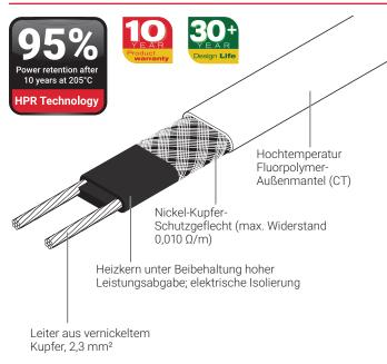
Das selbstregelnde Heizband nVent RAYCHEM HTV ist für den Frostschutz oder zum Halten der Prozesstemperatur bei Rohren und Behältern mit durchgängig sehr hohen Betriebstemperaturen (205 °C) ausgelegt.
