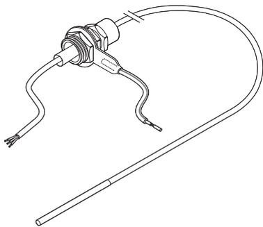
Zugelassene EEx e II-Kabelverschraubung ist an der Sensorleitung vormontiert (M16, Messing, inkl. Dichtungsscheibe, Gegenmutter und Erdungsglasche).
