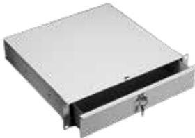
Cajón de acero para montaje en ángulo de rack de 19 pulg. que se monta en la superficie delantera de los ángulos de rack. La caja de acero integrada contiene el cajón y protege el componente interno que lo rodea. Se extiende 13 pulg. (330 mm) sobre guías con cojinetes esféricos. El frente incluye una manija y una cerradura con llave. El acabado es de pintura de poliéster pulverizado texturizado gris claro RAL 7035. Se incluyen los componentes para el montaje.
