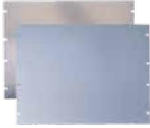
Los paneles de rack están disponibles en aluminio y acero pintado. Los paneles de rack de aluminio son de aleación 5052-H32 de 0.125 pulg. de grueso. Los paneles de rack de acero son de acero calibre 12 con Chapado de pintura pulverizada de poliéster gris claro texturizado RAL 7035. Todos los paneles son planos con orificios oblongos ubicados con espaciado EIA estándar. Los componentes para el montaje se venden por separado.
