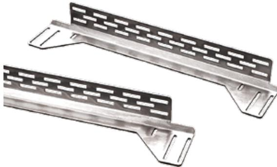
Los rieles de montaje permiten colocar los ángulos de rack en cualquier lugar del armazón ProLine. El ajuste de izquierda a derecha únicamente se aplica cuando el gabinete es más ancho que la anchura mínima requerida para los ángulos de rack. Incluye dos rieles de montaje derechos y dos izquierdos de acero calibre 12 chapado o pintado. Se incluyen los componentes para el montaje.
