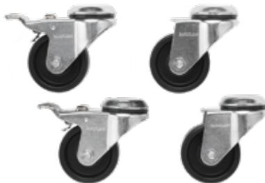
Un juego de cuatro ruedas (dos con bloqueo, dos sin bloqueo) que se montan directamente en la cubierta inferior de un marco ProLine, una base sólida de 0 mm o 100 mm o una consola. **(No utilizar en zócalos).** Las ruedas elevan el gabinete unos 110 mm (4,33 in) cuando se instalan. Los marcos de las ruedas están chapados en acero y tienen ejes con rodamientos esféricos. Las ruedas están fabricadas con poliamida negra. El juego incluye accesorios de montaje M12.
