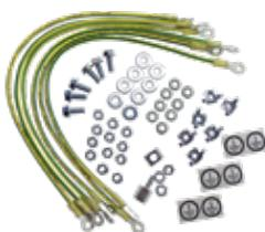
El juego de puesta a tierra permite conectar a tierra un gabinete ProLine o ProLine G2 según las especificaciones VDE. Incluye seis cables calibre 12 de 411 mm (16,19) de largo con terminales de anillo y accesorios de montaje M6.
