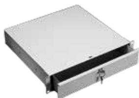
Un tiroir en acier pour un montage sur châssis de 19 po. S'installe sur la surface avant des cornières. Le tiroir est logé dans un boîtier en acier protégeant l'équipement intérieur environnant. Prolongement de 13 po. (330 mm) sur glissières à billes. La face avant comprend une poignée et une serrure à clé. La finition est une peinture en poudre de polyester gris clair texturé RAL 7035. La quincaillerie de montage est fournie.
