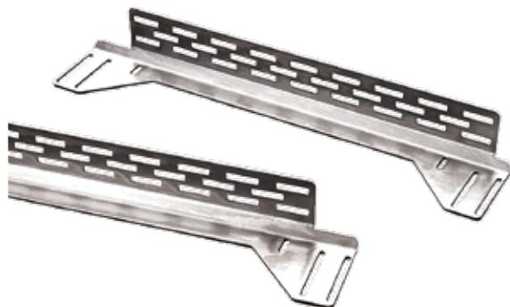
Les rails de montage permettent de positionner les cornières dans le cadre ProLine. Le réglage de gauche à droite ne s'applique que lorsque le boîtier est plus large que la largeur minimale requise pour les cornières. Comprend deux rails de montage en acier plaqué ou peint de calibre 12 à droite et deux à gauche. La quincaillerie de montage est fournie.
