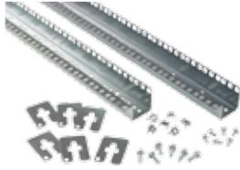
Les cornières à crémaillère de 23 po sont disponibles pour les applications de télécommunications. Elles se montent directement dans des cadres de 700 mm de large ou dans des cadres de 800 mm de large à l'aide de supports de réduction de cadre. Elles sont disponibles avec un espacement vertical des trous de 1,00 po.
