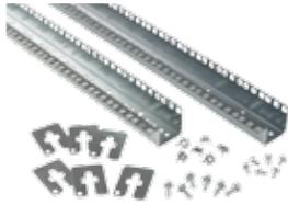
Les cornières à crémaillère de 24 po sont disponibles en version à trous carrés et à trous taraudés. Les cornières taraudées sont en acier plaqué de calibre 12 avec des trous taraudés de 10-32. Les cornières à trous carrés sont en acier plaqué de calibre 14 et sont conçues pour accepter les écrous à cage métriques ou anglo-saxons. Les cornières de 24 po se montent directement dans des cadres de 700 ou 800 mm de largeur à l'aide Supports de réduction de cadre.
