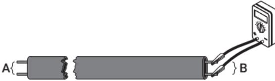
Abbildung 14: Berechnung des Widerstandes des HWAT-Heizbands
