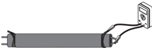
Abbildung 15: Kapazitätsprüfung
