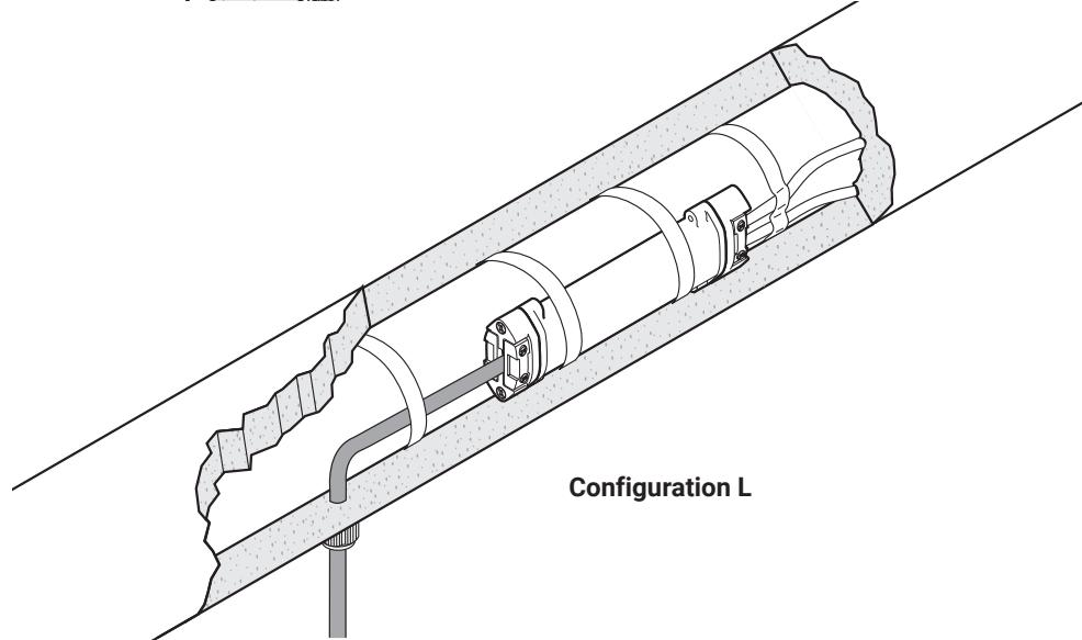
**⚠** Les câbles raccordés au kit doivent être fixés des deux côtés du kit.
