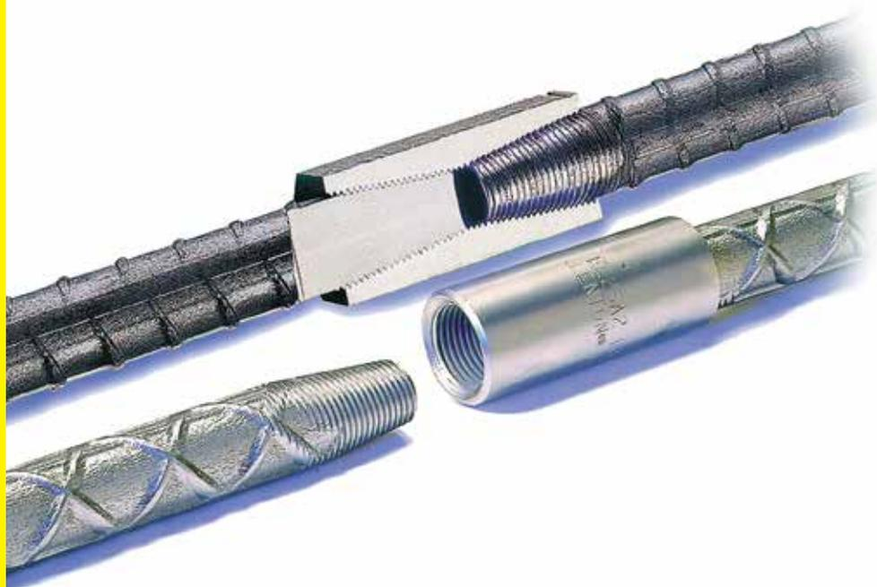
Die LENTON-Schraubmuffenverbindung von Pentair gestattet es, einfach, sicher und schnell Betonstahlverbindungen von  $\varnothing 10$  bis  $\varnothing 57$  mm herzustellen und ist sowohl für Zug- als auch Druckbelastung ausgelegt. Wesentlicher Bestandteil des LENTON-Systems ist das selbstsichernde Kegelgewinde. Ohne Kontermuttern greifen die zu verbindenden Stabgewindeflanken beim Verspannen schlupffrei ineinander. Schlupf  $< 0,1$  mm.
