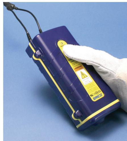
**PASSO 4** Pressione e mantenha premido o botão de accionamento. Após 10 segundos, abra o molde.
