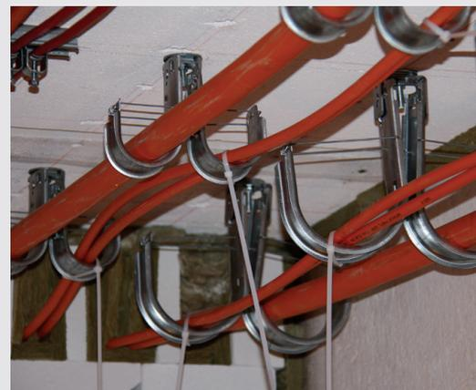
Supporti a J e cavi nella camera d'incendio prima delle prove di resistenza al fuoco
