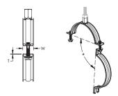
Werkstoff: Stahl Oberfläche: elektrolytische Verzinkung Temperatur: -50 bis 110 °C
