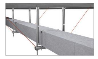
Les standards sismiques internationaux acceptent l'utilisation de renforts parasismiques rigides et par câbles. Les systèmes de renfort parasismique par câbles ont l'avantage d'être à la fois polyvalents, légers et faciles à transporter.
