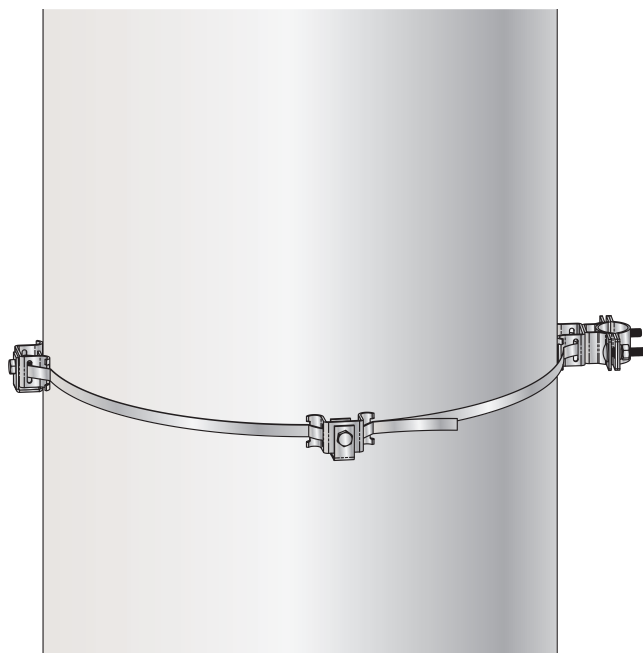
Abbildung 43 – Installierte Anordnung an großem Rundmast
