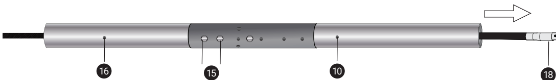
Figure 21 : Faire passer le conducteur interne dans le mât
