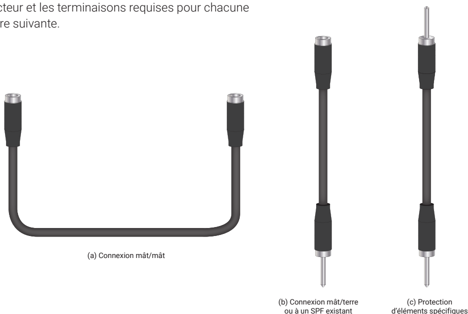
Figure 55 : Fonctions et terminaisons requises des conducteurs
