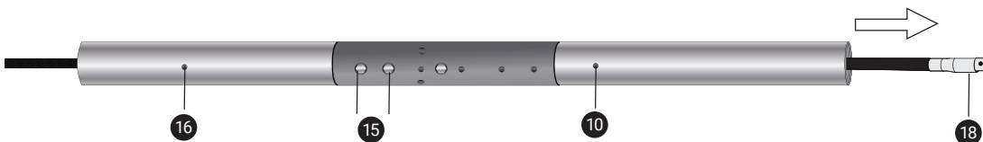
Fig. 21 – De interne geleider door de mast steken
