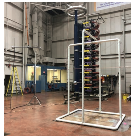
Labortests zur Überprüfung des äquivalenten Trennungsabstands, sowohl für das Kabel als auch für den freistehenden Mast
