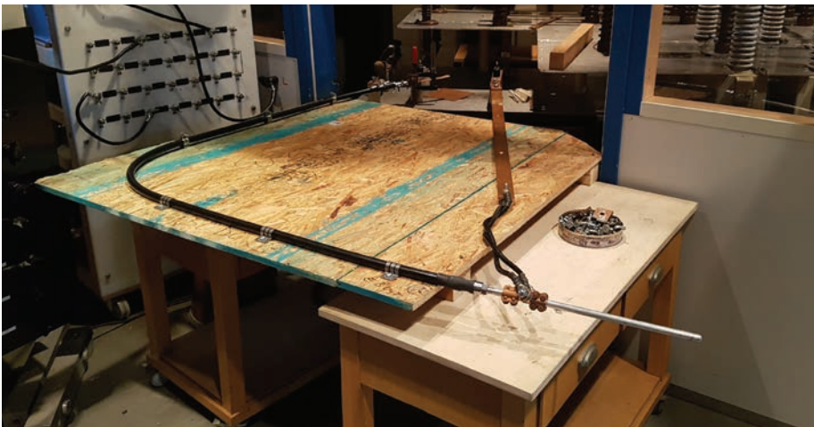
Labortests zur Überprüfung der 200kA-10/350us-Auslegung für das Kabel mit Anschlüssen und Befestigungen
