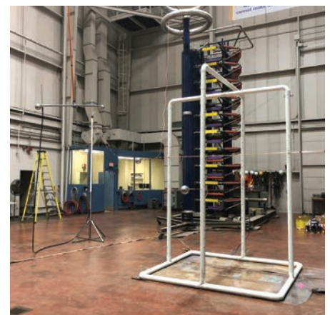
Essai en laboratoire permettant de vérifier la distance de séparation équivalente avec câble et mât autoporteur
