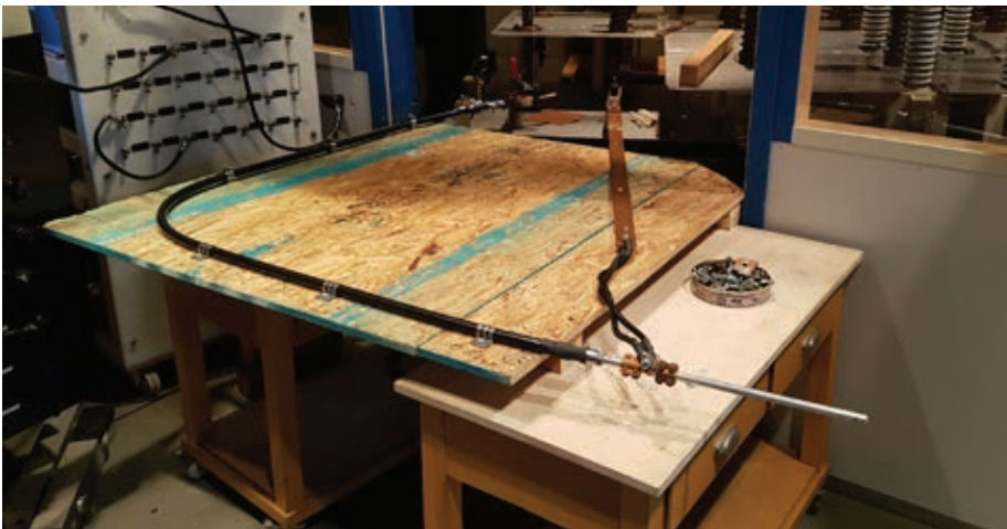
Laboratoriumtests om de 200kA 10/350us-waarde voor de kabel met connectoren en bevestigingsmiddelen te controleren
