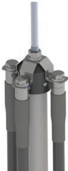
Er kunnen maximaal vier geleiders worden toegevoegd rond de buitenkant van de mast, naast de geleider die altijd in de mast aanwezig moet zijn.
