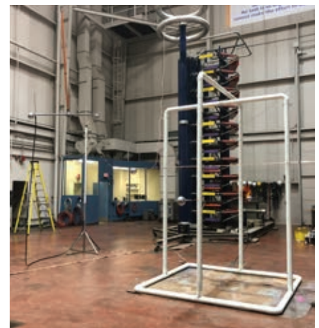
Laboratoriumtests om Gelijkwaardige scheidingsafstand inclusief kabel en vrijstaande mast te verifiëren
