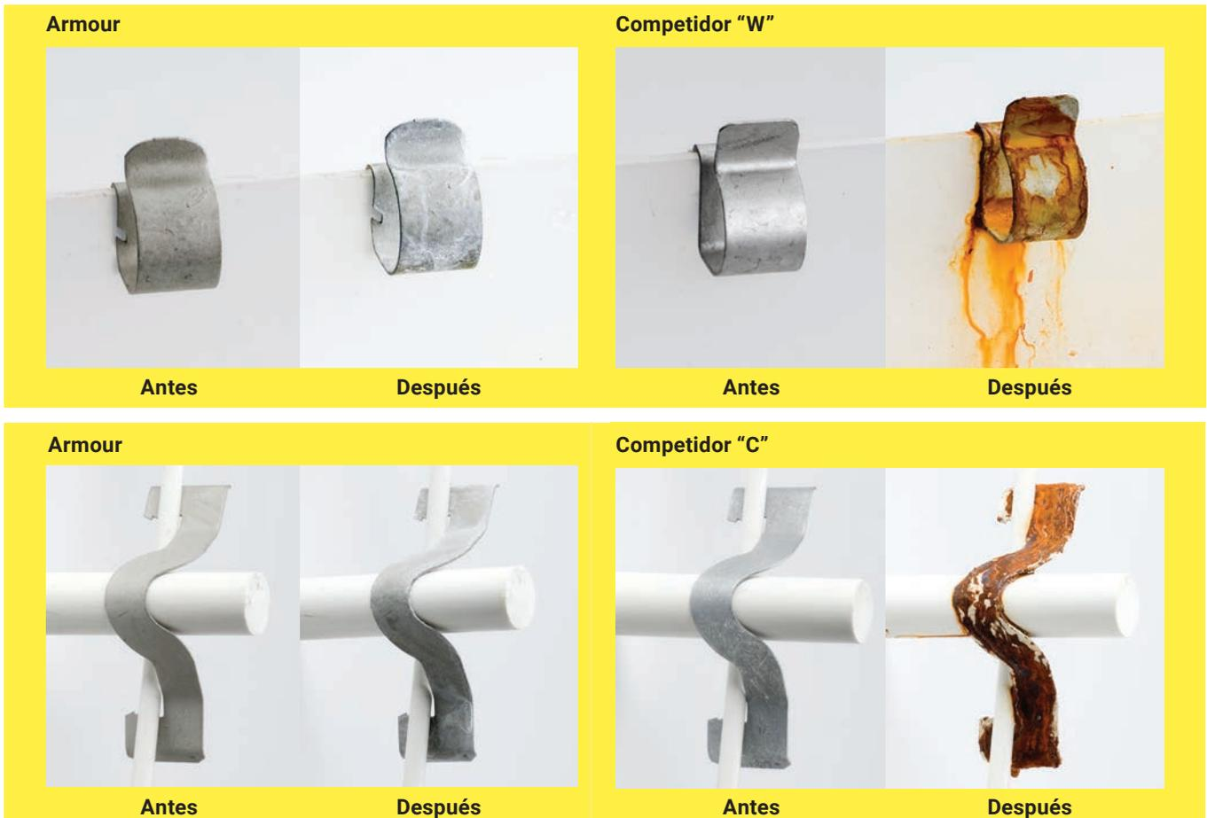
\* Ensayo de niebla salina de acuerdo con: ASTM B117/DIN 50021; Ensayo de corrosión cíclica de acuerdo con: GM 9540P. Visite <https://www.nVent.com/our-brands/CADDY> para ver los términos de la garantía limitada de 10 años de Armour.
