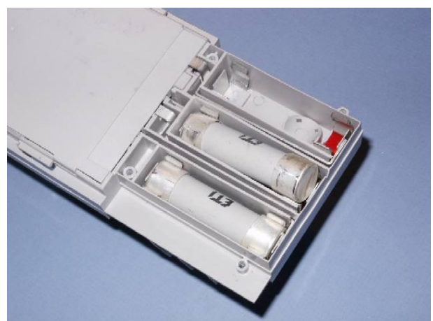
Paso 4: El tornillo eyector levanta un extremo del fusible, que ahora pueden se puede retirar. El uso del mecanismo de tornillo eyector evita dañar la bandeja de plástico.
