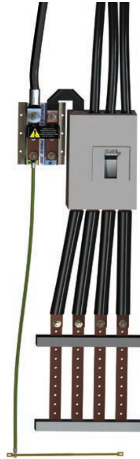
Esquema TN-S alimentación directa de potencia
