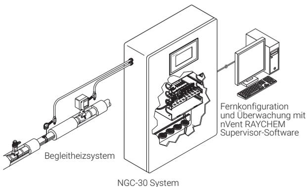
Das nVent RAYCHEM NGC-30 ist ein elektronisches Mehrkanalsystem zur Regelung von Begleitheizungsanwendungen. Es wird für die Prozesstemperaturhaltung und Frostschutzanwendungen verwendet. Der NGC-30-Regler kann Temperatureingänge von zahlreichen Quellen verarbeiten: fest mit den auf der Schalttafel montierten CRM(S)-Modulen verdrahtet oder von Fernüberwachungsmodulen (RMM2).
