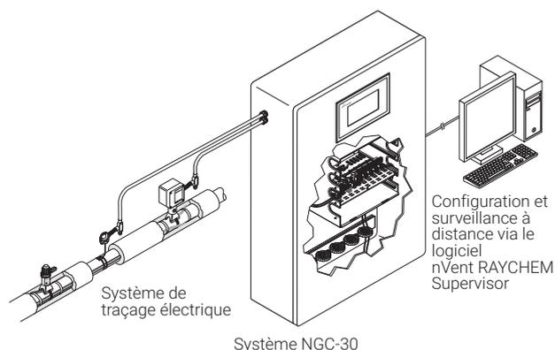
Le modèle nVent RAYCHEM NGC-30 est un système de régulation électrique destiné aux applications de traçage multicircuits, spécialement conçu pour la mise hors gel et le maintien en température des procédés. Le régulateur NGC-30 peut gérer des entrées de température de sources variées : entrées câblées aux modules CRM montés dans l'armoire ou provenant de modules de surveillance à distance (RMM2).
