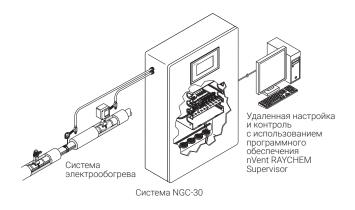
Система nVent RAYCHEM NGC-30 представляет собой систему электронного управления несколькими цепями электрообогрева для обеспечения защиты от замерзания и поддержания технологической температуры. В контроллере NGC-30 предусматривается возможность получения температурных данных от различных источников: по аппаратным подключениям с установленных на панели модулей CRM(S) и с удаленных модулей контроля (RMM2).
