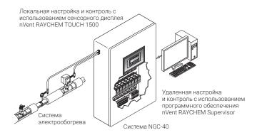
Система nVent RAYCHEM NGC-40 представляет собой многоточечную систему электронного управления с уникальными контроллерами с одноэлементной архитектурой для электрообогрева при поддержании технологической температуры и защиты от замерзания. Благодаря инновационным методам модульной комплектации системы управления NGC-40 обеспечивают гибкость настройки и компонентного состава для удовлетворения требований конкретного заказчика.
